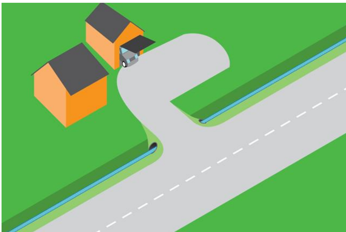
Figur 3 Vann langs veien og fra terrenget må ledes forbi. Illustrasjon: Statens vegvesen.
