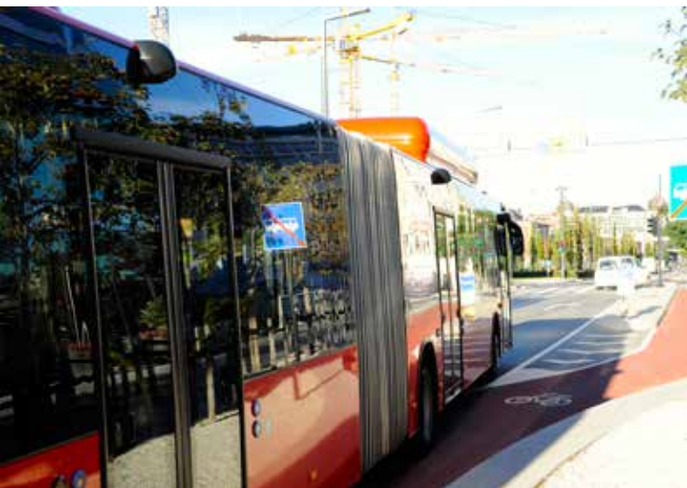
Dårlig planlegging III: En lang leddbuss sperrer sykkelfeltet.
