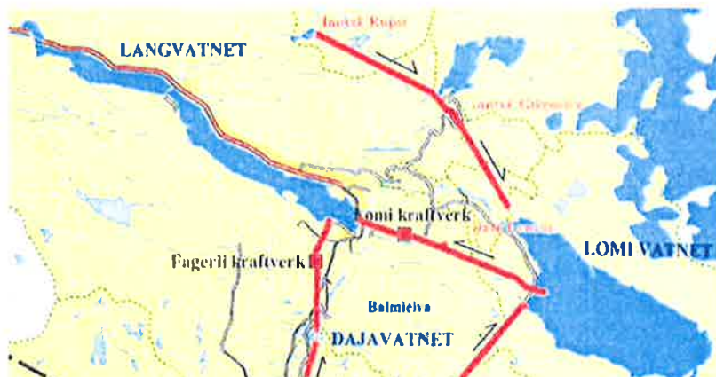
Figur 30 Oversikt over overføringsledninger i Sulitjelmavassdraget (røde linjer). Utslipp fra Lomi og Fagerli kraftverk ledes til Langvatnet. Figur fra SKS, 2015
