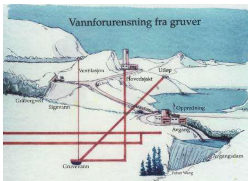
Figur 1 Oversikt over vannforurensning fra gruver. Kilde KLIF (2010)
