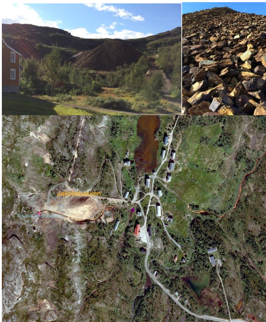
Figur 33 Jakobsbakken med deponi fra gruvedrift. Bekker og vassdrag viser tydelig oker utfelleing på flyfoto under. Vannforekomstene (rosa punkt) er påvist sterkt forurensset av utslipp fra blant annet gruvevann fra Nils-stoll og deponiet utenfor stollen (orotofoto).
