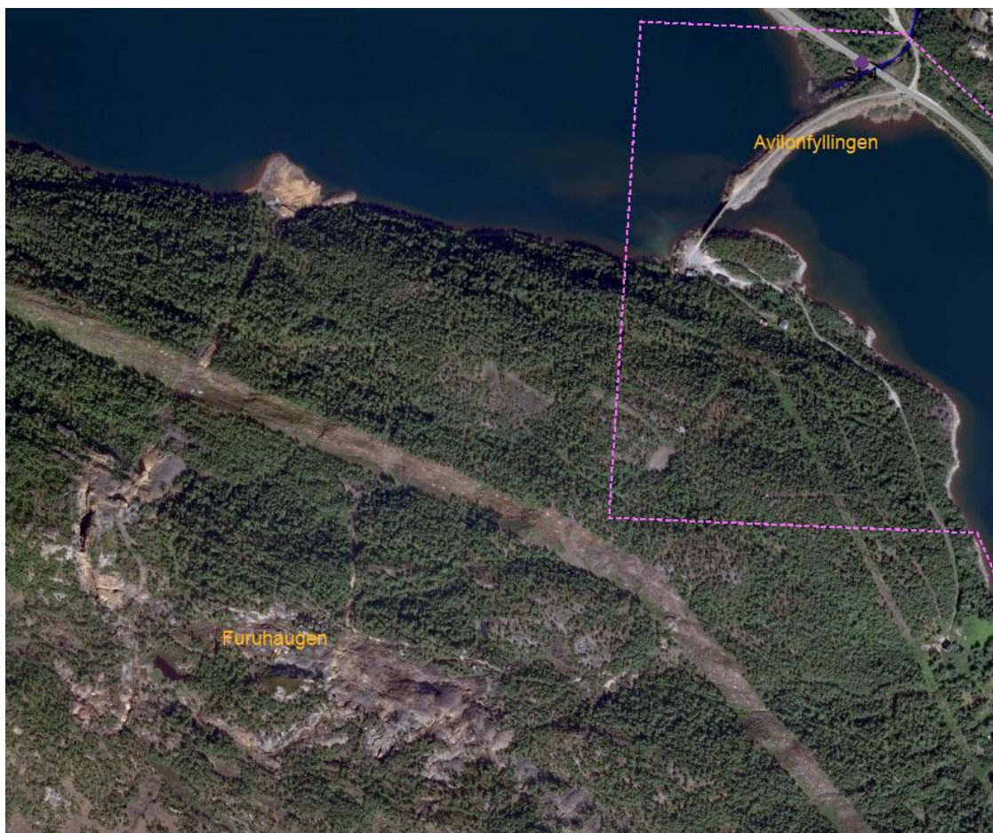
Figur 28 Flyfoto over Furuhaugen gruveområde med Furuhaugbekken ned til Langvatnet. Tipp fra gruve drift er synlig på flyfotoet ved munningen av Furuhaugbekken.
