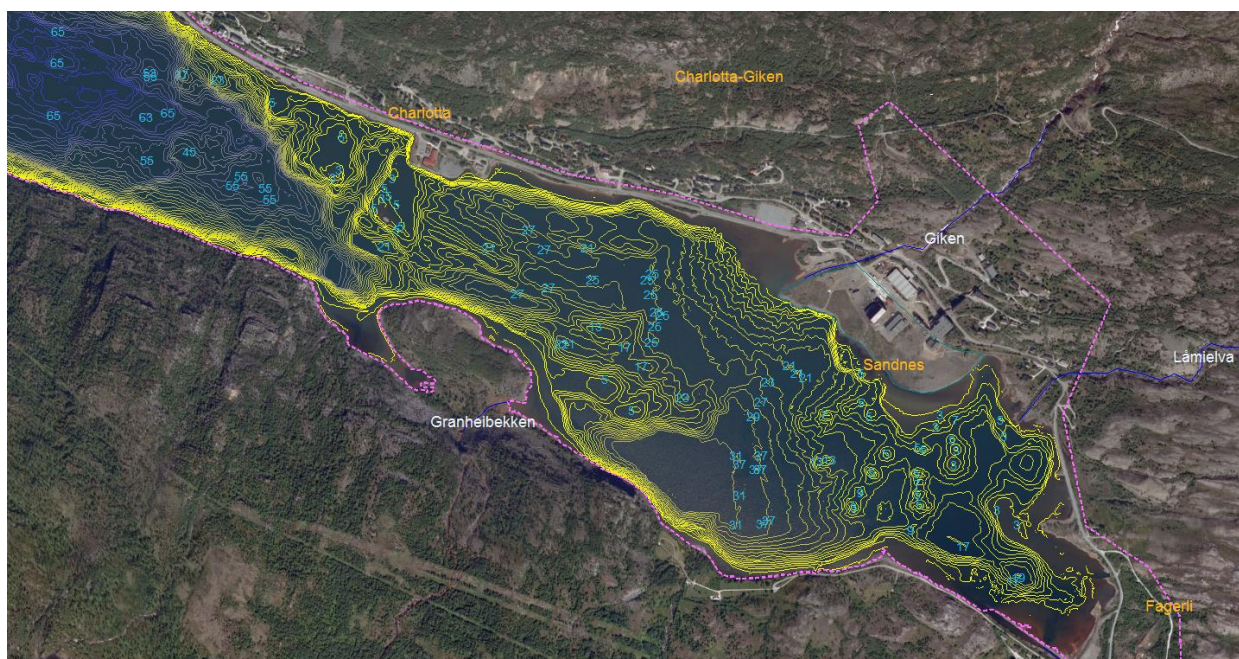
Figur 16 Dybder Langvatnet østre/indre. Dypet varierer fra 3 -21 meter fra innerst i Langvatnet ved Sandnes til litt vest for Charlotta. Data er hentet fra kart fra Fauske kommune 2014.
