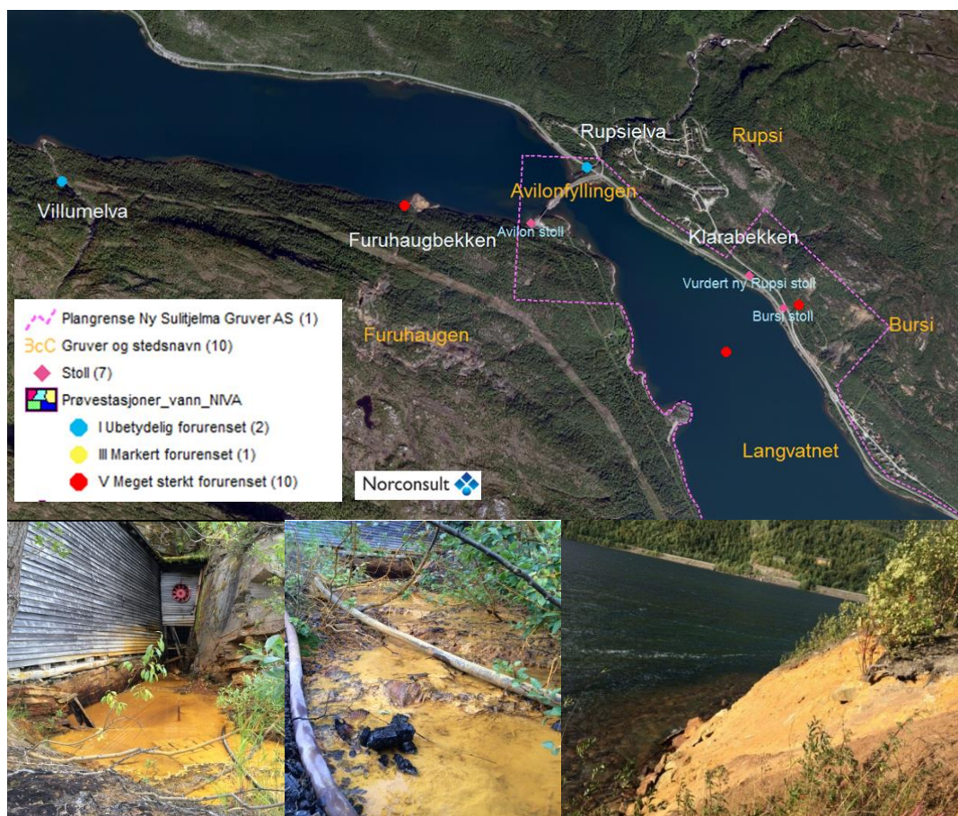
Figur 27 Utslipp av gruvevann fra Sagmo gruve i Sørgruvefeltet via Avilon-stoll til Langvatn vest for Avilonfyllingen.
