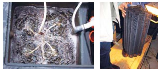
Dykket biofilmanlegg og til høyre bilde av biofilmmidiet.
