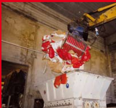
Posene og annet brennbart lastes over i det moderne brikettanlegget der det finsorteres og kvernes.
